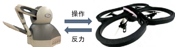
ハプティックデバイスを用いた飛行ドローン操縦インターフェース (左:ハプティックデバイス, 右:飛行ドローン)
