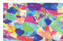
10μm ナノ粒子を用いた粒界制御 ポリSi結晶デバイス
