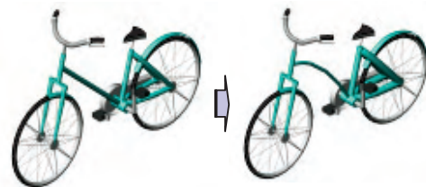
上品さを考慮した強度最大化フレーム
