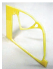
コンプライアントサスペンションの設計例(小型モデル)
