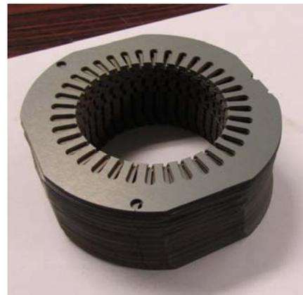
図4. モータの製作。電磁鋼板からワイヤ放電加工を用いてモータを製作し、モータシミュレータで実測評価する。電磁鋼板の鋼板厚みを変えた時、インバータ励磁時の鉄損促成がモータ時にどうなるかを検証する。
