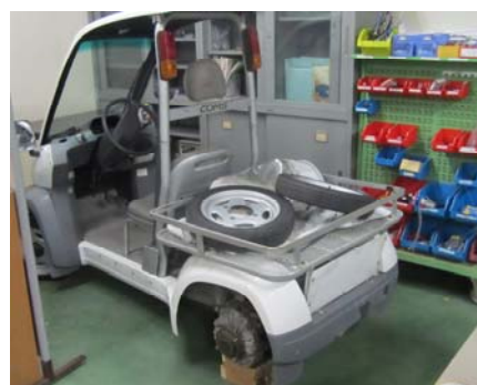
図5. 電気自動車での高効率評価. 高効率小型軽量なモータ駆動システムを電気自動車にて走行評価すべく、COMS を解体中。電気モータを活かした EV の将来図を示していく。
