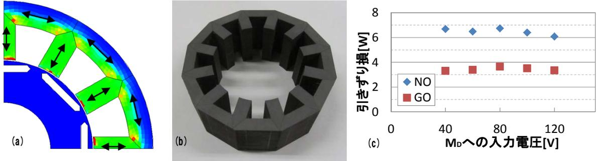
図3. 材料特性を活かした異方性モータ研究, (a) 数値解析によるコア形状設計 [6], (b) コア試作, (c) 無垢鉄による鉄損評価 [7]
