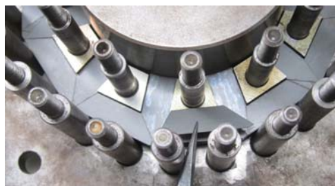
図2. 「異方性モータ」による鉄損低減・試作:磁気異方性は強いが磁気特性に優れたGO材を適切に使用することにより鉄損で4割低減しうたことを解析で示し、ステータコアを試作している。写真はコアの製作状況。
