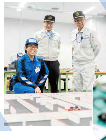
光センサーや超音波センサーを組み込むなど電子工作を実践し、C言語によるプログラミングを駆使して、迷路の記憶・探索・走行制御を実現します
