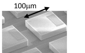
垂直壁配線を利用した100セル接続マイクロ太陽電池 (IoTデバイスの電源応用)
