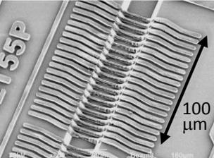
段差を越えて形成した磁気センサ用微細コイルパターン (携帯電話の電子コンパス)
