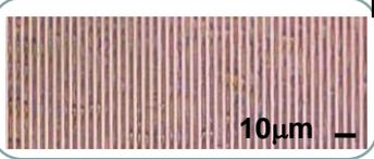
φ25mmレンズ曲面に一括形成したピッチ4μmの格子 (コンタクトレンズ型デバイスなどの応用)
