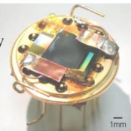
垂直壁面に製作した立体配線パターン (光通信素子の実装応用)
