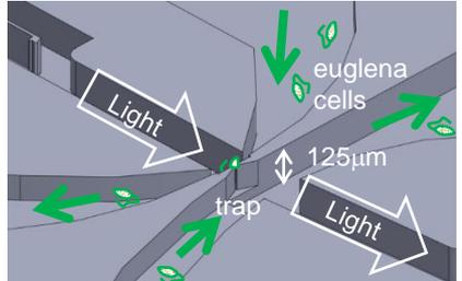
光ファイバと組み合わせるミドリムシ細胞トラップ付きマイクロ流路
