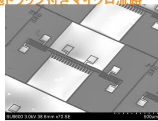
絶縁型高電圧センサ(電気自動車などの電池モニタ応用)
