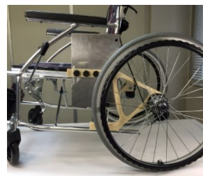
コンプライアントサスペンションの試作例 (左: 自動車用の小型モデル, 右: 車いす用の組み込み例)
