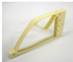
コンプライアントサスペンションの試作例 (左: 自動車用の小型モデル, 右: 車いす用の組み込み例)
