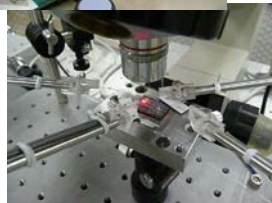
真空プローバなど 各種自作装置 いろいろ
