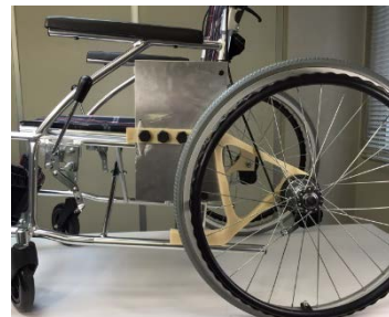
コンプライアントサスペンションの試作例 (左: 自動車用の小型モデル, 右: 車いす用の組み込み例)
