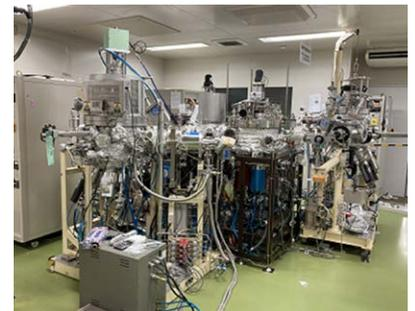
3台のマグネトロンスパッタ装置を連結した多機能成膜装置。真空を破ることなく13種類の元素を自由に積層することが可能。
